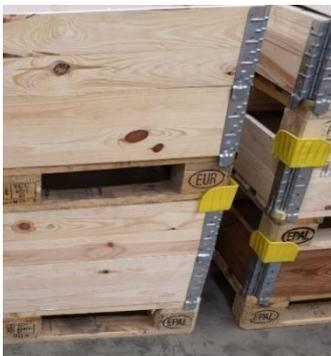
Abbildung 6 Sicherung der Stapelung von Paletten mit Klapprahmen durch Stapelecken
